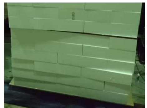
写真-3 加振後の変状 (新型金具, 新配置)
