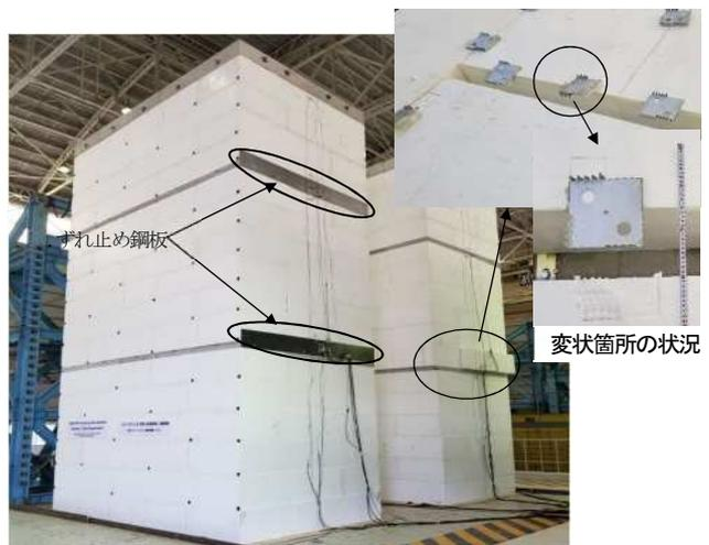
図-20 実験後状況 (ケース 7, 手前がハイブリッド配置)
